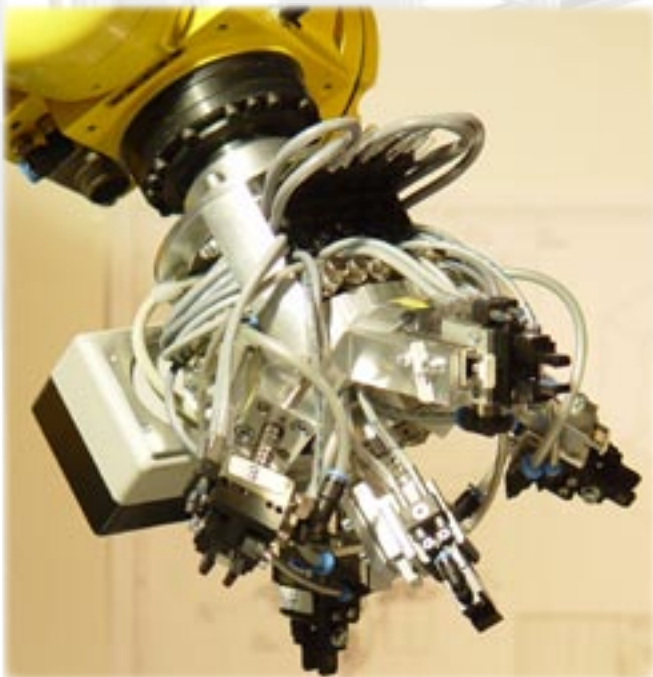
Anwendungsbeispiel 5-fach Greifer 8 Ausgänge, 16 Eingänge
